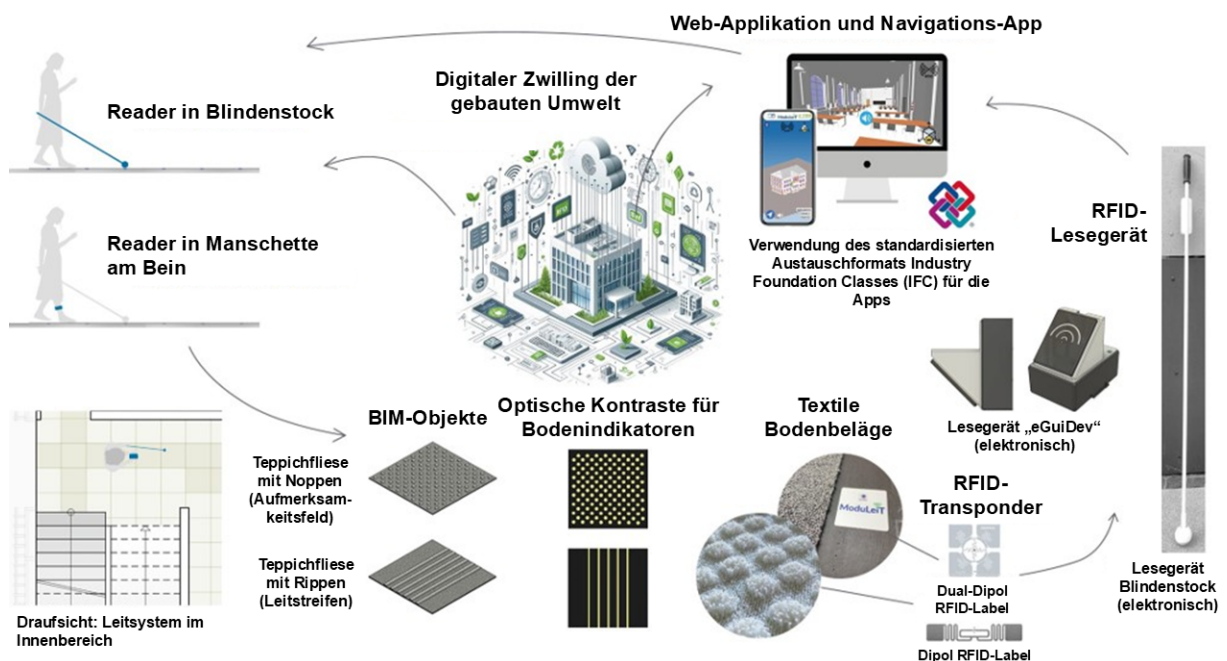
Bild 1: Big Picture der Zusammenhänge zwischen den einzelnen Faktoren für den Aufbau von barrierefreien Gebäuden mit RFID-basierten textilen Bodenindikatoren (Quelle: ModuLeiT Forschungsprojekt)
