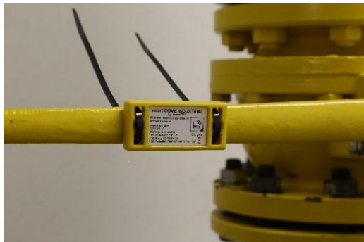
smart-DOME Industrial mit Kabelbindung an industrieller Anlage befestigt
